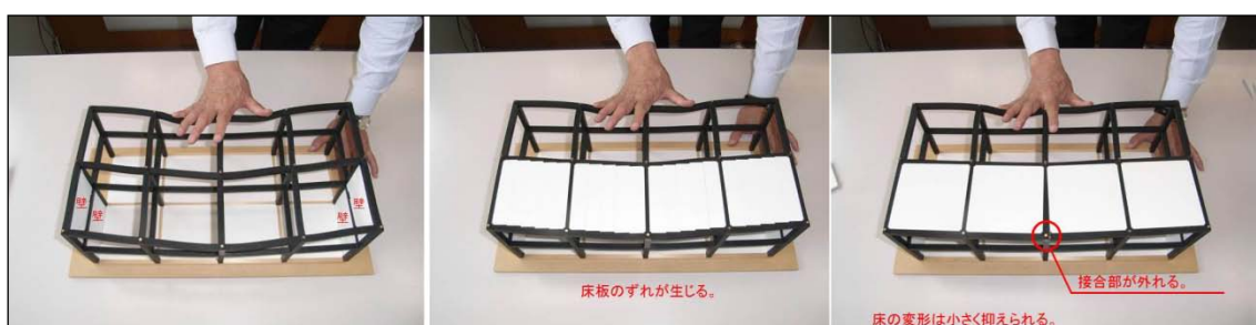
図 4-8 フレームのみ（左）、柔床（中央）、剛床（右）
