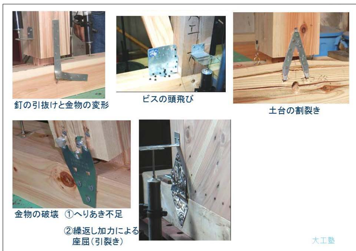
図 3-17 金物の破壊性状
