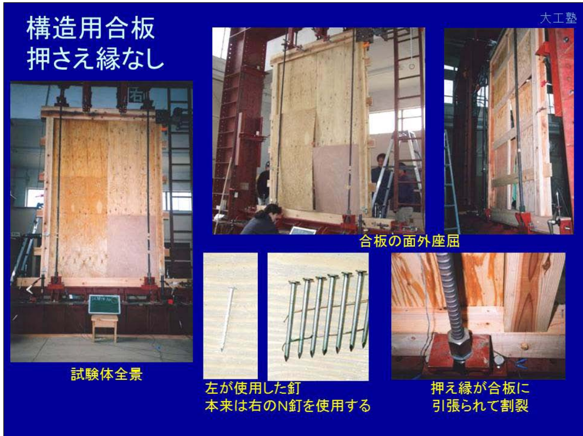
図 5-7 構造用合板押さえ縁なしの実験
